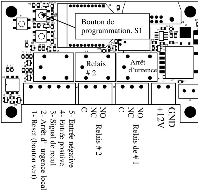
Le bouton (S1) situé sur le circuit imprimé du boîtier récepteur permet à l'utilisateur de lui associer une télécommande. En pressant une seconde sur ce bouton, le témoin lumineux situé juste à côté s'allume. En pressant sur le bouton d'une télécommande, le boîtier récepteur mémorise son numéro et fait clignoter deux fois le témoin lumineux afin de confirmer l'association du boîtier à la télécommande.
